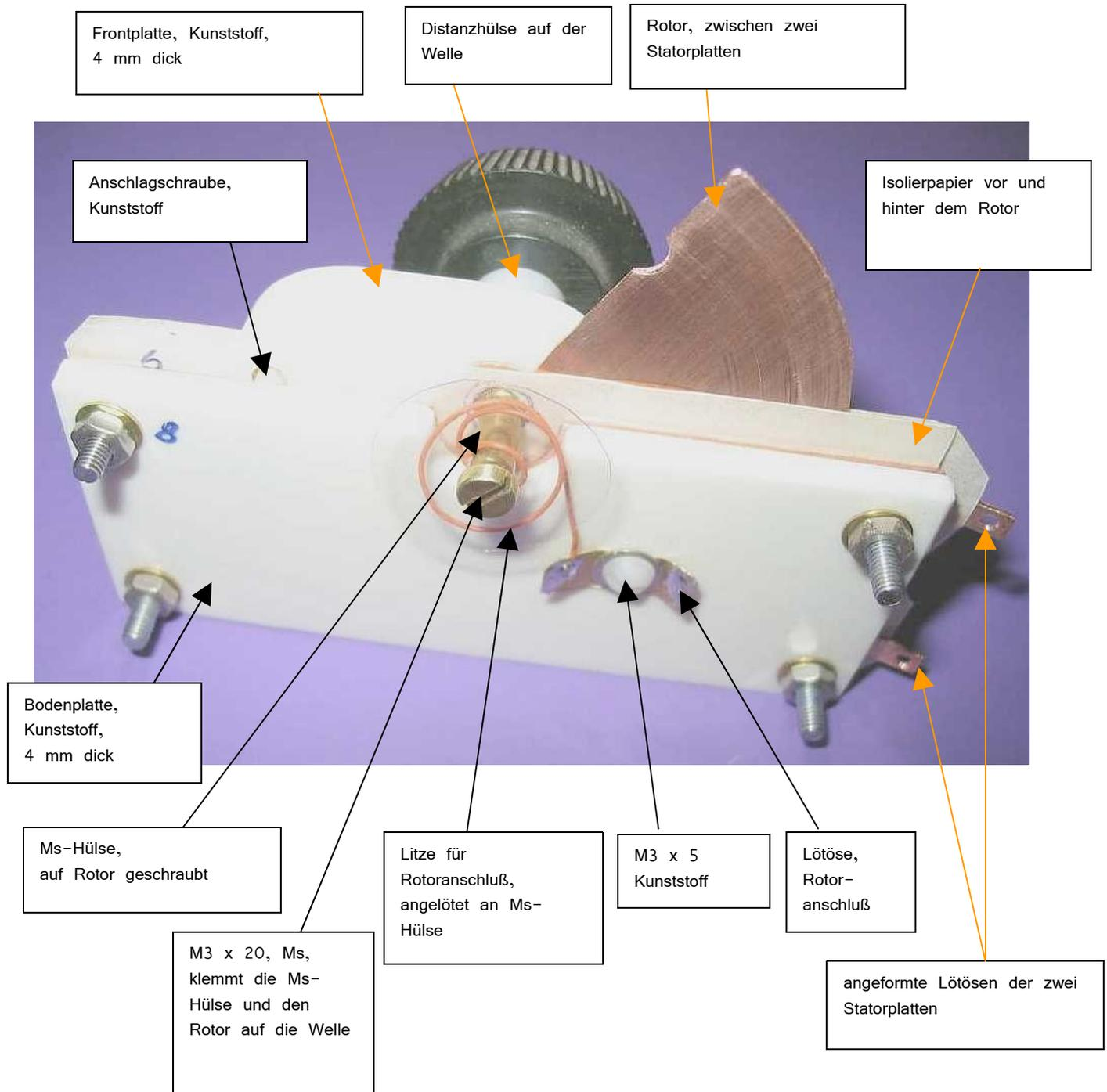
Hinweis: Bei Empfängern mit großer Trennschärfe (kleiner Bandbreite), z.B. Audion, kann das Einstellen eines Senders etwas knifflig sein, weil durch Verkantung der Welle (was beim Betätigen des Drehknopfes ungewollt vorkommen kann) eine Kapazitätsänderung erfolgt: Der Abstand zwischen Stator und Rotor wird geringfügig anders und dadurch die Resonanzfrequenz und damit die Abstimmung.
